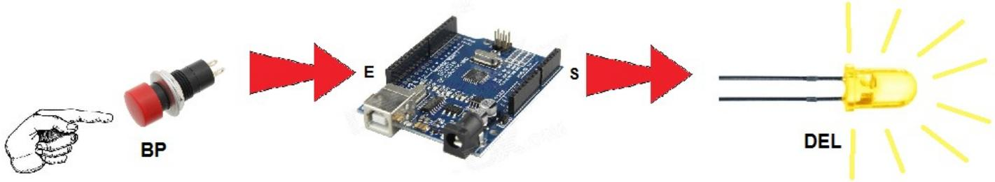
Nous connectons le bouton poussoir à une entrée (E) de la carte Arduino et notre lampe (diode lumineuse) à une sortie (S) de la carte.
