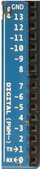
Chacun des connecteurs D0 à D13 peut être **configuré par programmation en entrée ou en sortie**, nous pouvons donc avoir par exemple les connecteurs 2 et 3 configurés comme des entrées et les connecteurs 7, 8 et 9 configurés comme des sorties.
